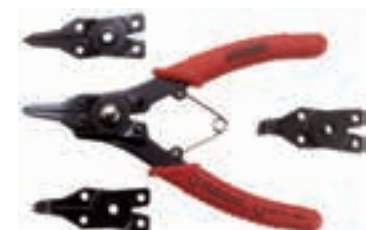
Universele circlipstang met 4 verwisselbare koppen die 8 verschillende combinaties mogelijk maken. Zowel voor inwendige als uitwendige circlipsen. De tips zijn licht magnetisch. Met terugveer. Met vinyl-bekleed handvat.
