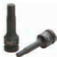
Slagdopbitsen 1/2" hex voor interne openingen. Lange versie L.78mm. Chroom molybdeen kwaliteit. De doppen zijn voorzien van een opening voor de vasthoudpin.
