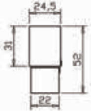
Voor ML 80 tot 720mm Totale lengte is ML + 138mm Installatie lengte is ML + 124mm
